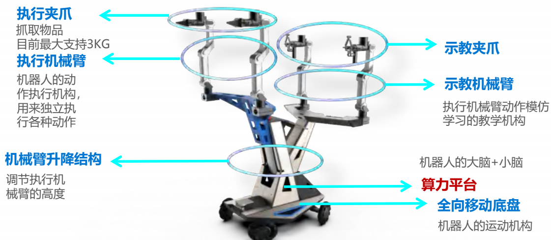
图示：Fibot具身智能机器人开发平台 数据来源：广和通，36氪研究院整理
