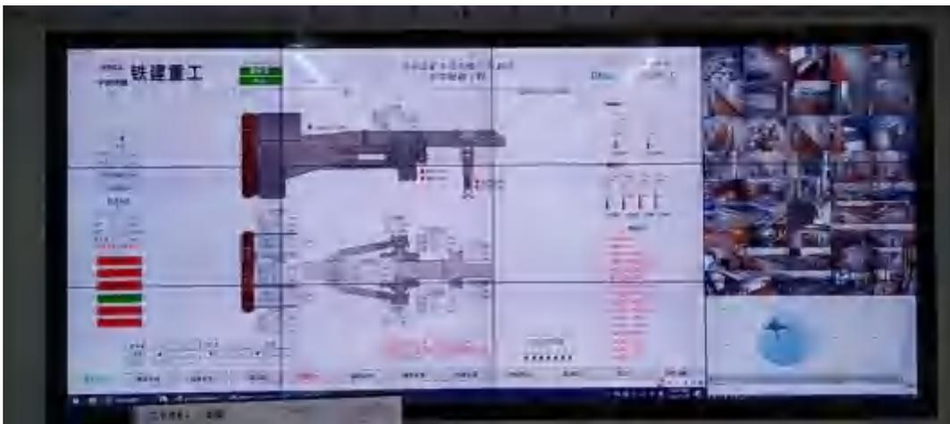
图2 掘进机智能控制系统
