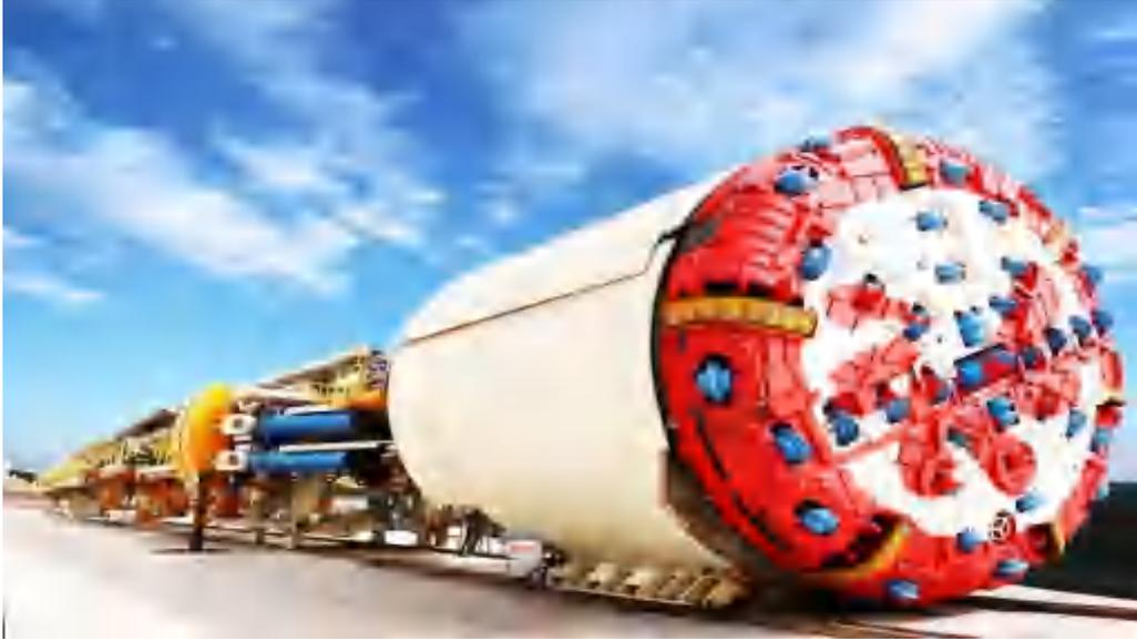
图1 全断面掘进机主机组装完成
