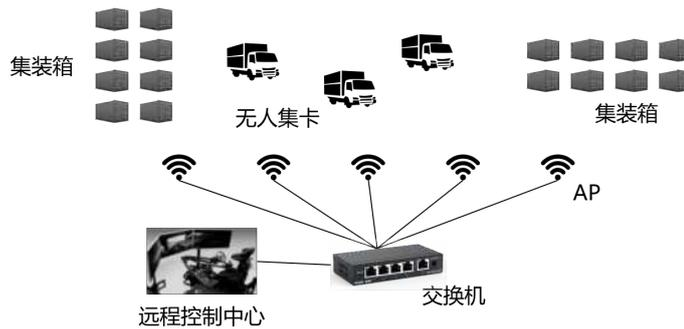
图9 智慧码头系统架构
